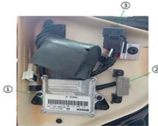
1. ECU 2. OBD 3. Предохранители
